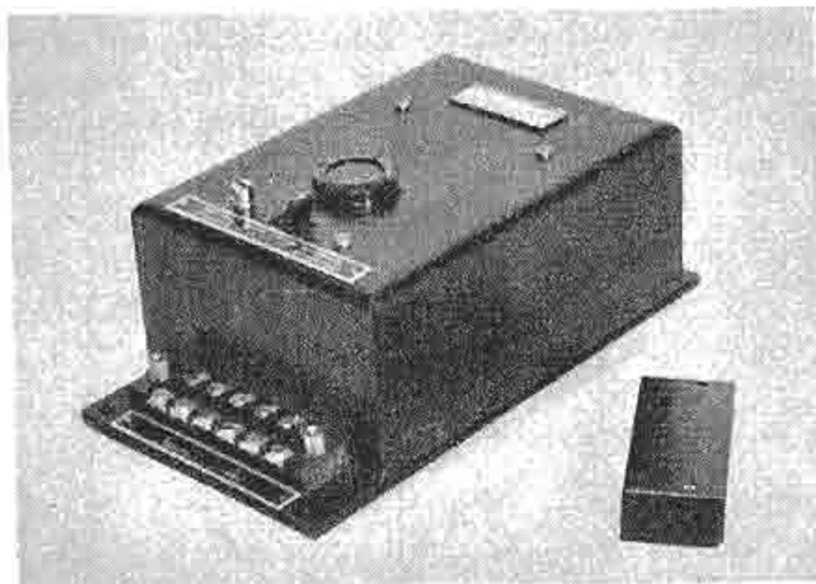
Der Störungsmelder zeigt auftretende Störungen im Sprachspeicher optisch u. akustisch an
