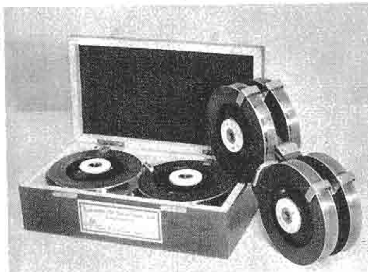
Ersatzkassette; der Exzenterhebel befindet sich unten und legt sämtliche Drahtspulen fest
