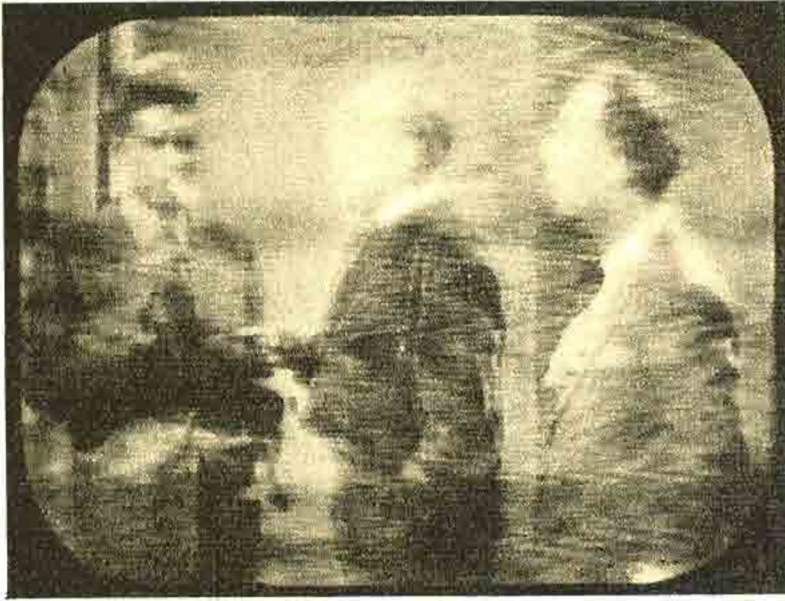
Abb. 4. Tonmodulation im Bild durch größere Verstimmung in Richtung des Tonsenders
